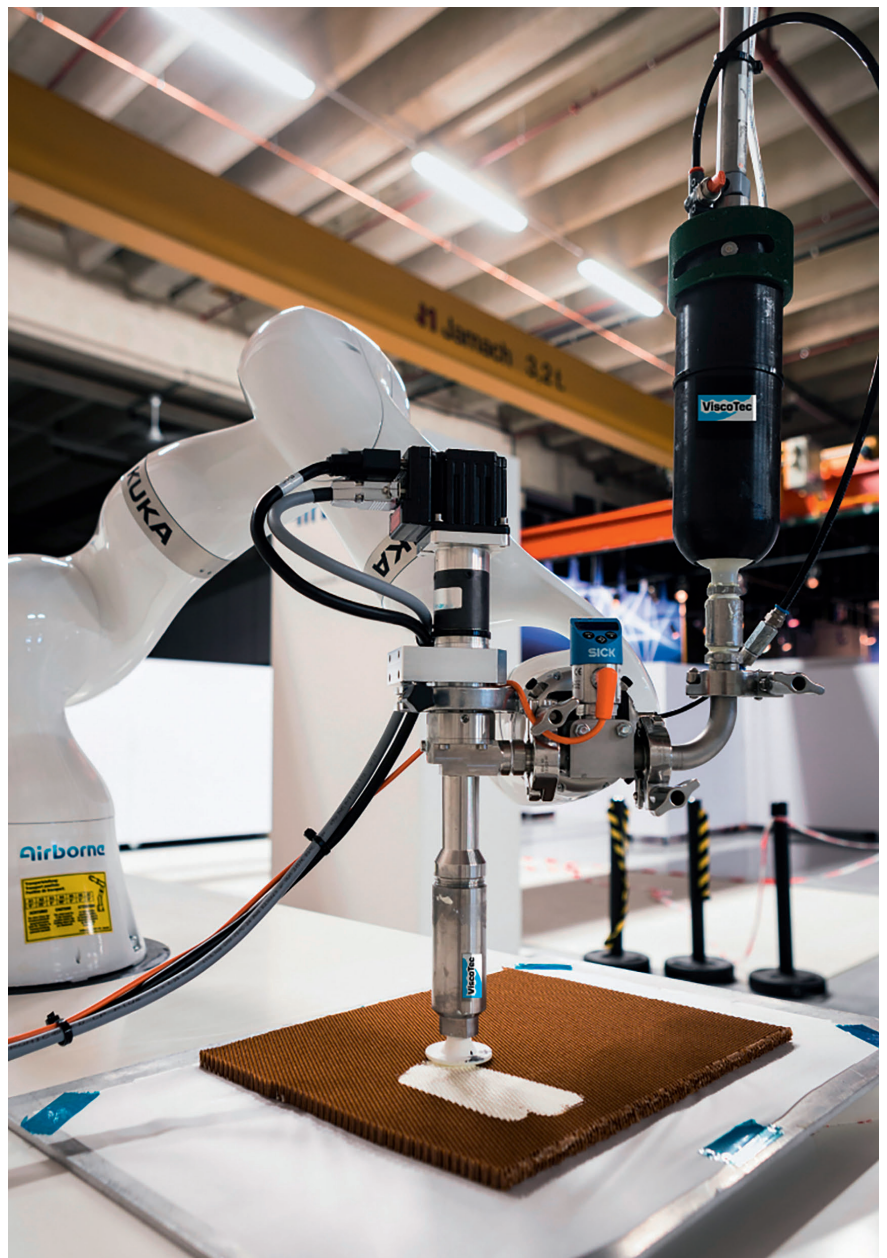
Einhanddosiersystem: Eine automatisierte Befüllung der Wabenzellen reduziert die Produktionskosten um bis zu 30 % (© Airborne)
